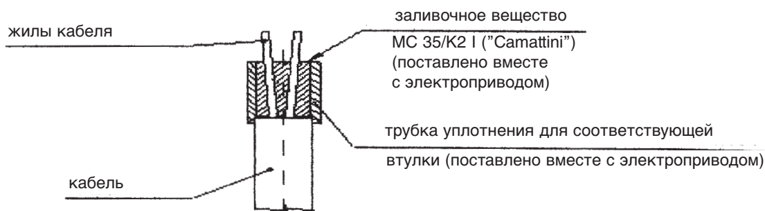
Рис. 5 – уплотнение жил кабеля заливочным веществом
